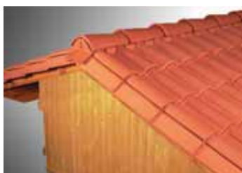
Emploi de closoirs de faitage et bardelis "S". Fixation du fronton par vis et rondelle d'étanchéité.
